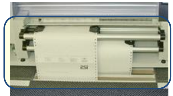
2 Ouvertures alimentation papier (tracteur supérieur / inférieur)
