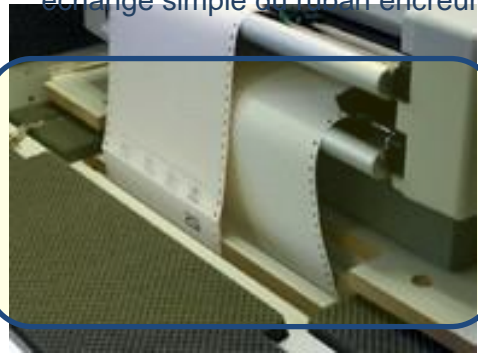
Plateau imprimante extensible pour échange simple du ruban encreur
