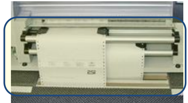
2 Ouvertures pour l'alimentation papier tracteur (supérieure/ inférieure)
