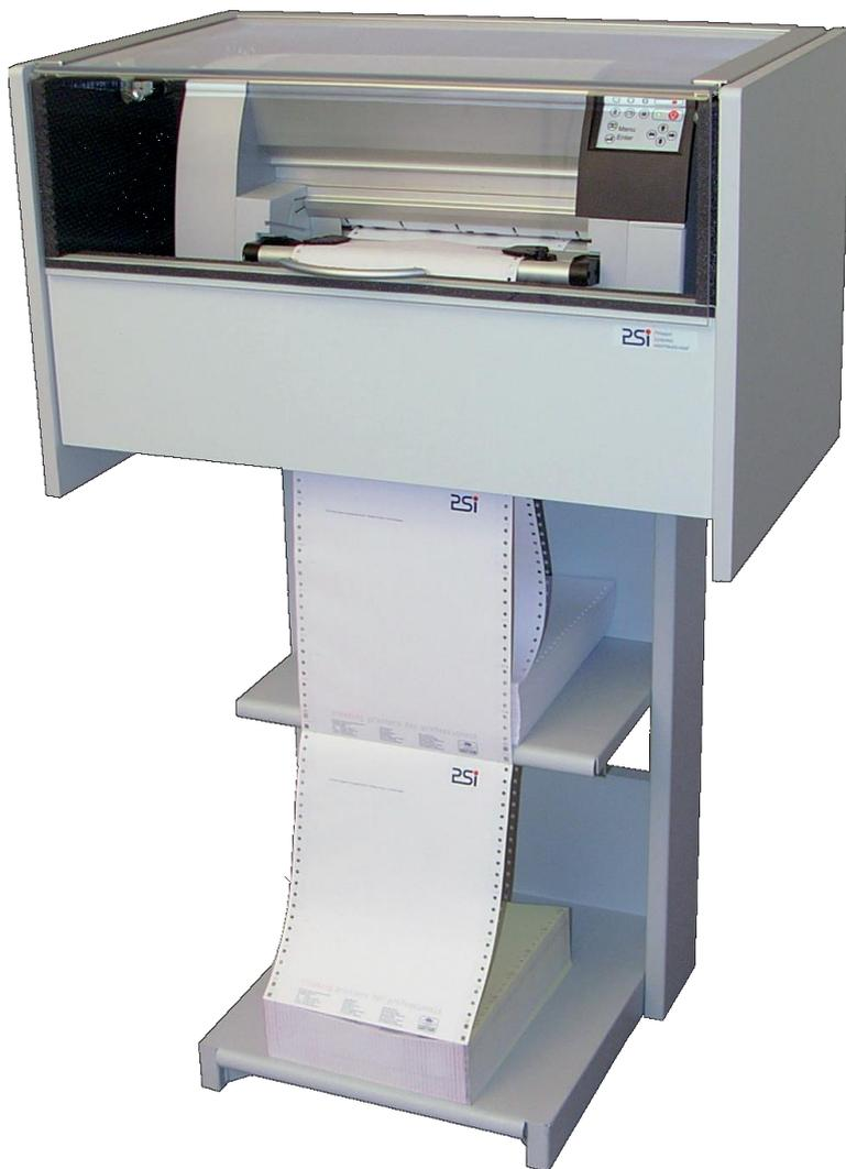
Schalldämmhaube montiert auf dem Standfuß
