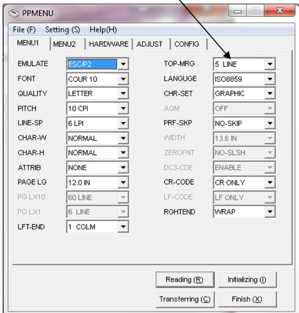
Ein 1. Zeile Einstellung wird allerdings nur ausgeführt, wenn im Menu/Conig der Parameter TOF-CTL auf „Setup“ gesetzt ist.
