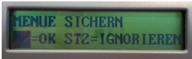
Mit der **STOP** Taste Menü sicher. Der Drucker startet neu.
