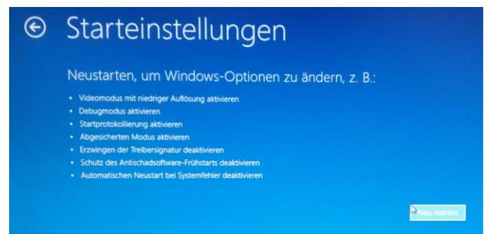
Nachdem Neustart erhält man ein Menü mit Starteinstellungen. Durch drücken der Zifferntaste 7 “Erzwingen der Treibersignatur deaktivieren” Startet das System neu.
